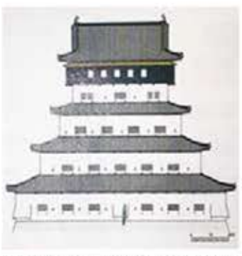
原小倉城を描いた小倉城天守復元立面図 (三浦正幸・前広島大学大学院教授提供)
